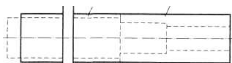
Рис. 2.2. Поковка, штампованная на ГКМ
